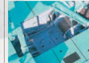
コンパクトな湿式ウインチとサイドエンジンレイアウトの採用により、オプションのサードラムは主・補巻同一サイズの大容量。基礎・土木作業にもきっちりと対応できます。
